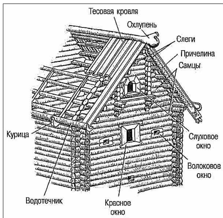
Рис. 42. Схема наименований деталей конструкций русской избы (по В. М. Красовскому)
